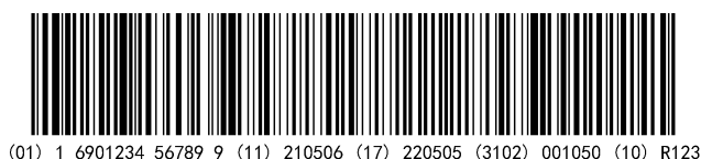
图 A.7 用于非零售食品追溯的 GS1-128 码示例
